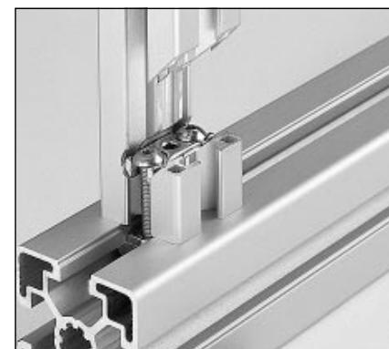
Beim Bolzenverbinder werden Kräfte symmetrisch über zwei Schrauben in den stabilen Profilkern eingeleitet. Damit ist er für hohe Belastungen - auch Torsion - geeignet.
