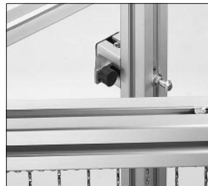
Die Anschlagpuffer werden zur Geräuschdämpfung und zur Schonung des Materials bei Türen eingesetzt.
