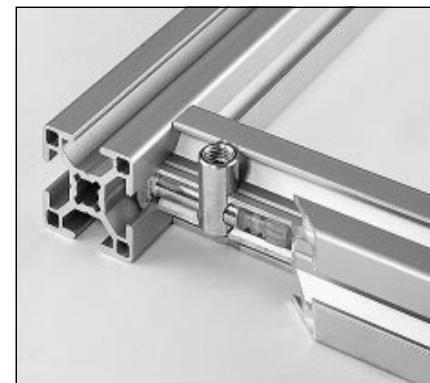
Der Schnellspannverbinder ist ein universeller Eckverbinder für den Bau von Gestellen, Schutzeinrichtungen o. ä.. Gute Zugänglichkeit stellt die einfache und schnelle Montage sicher. Drei Nutten bleiben zur Aufnahme von Flächen-elementen frei.
