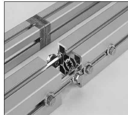
Endverbinder mit selbstschneidenden Schrauben für leicht zerlegbare Streben aus Profil 45x45. Die Profilnute bleibt frei.
