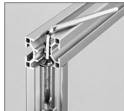
Die Zentralschrauben sind das kostengünstigste Element zur Verbindung von Profilen. Bei den selbstformenden Schrauben A, B und D entfällt die Profilendenbearbeitung. Wegen des breiten Schraubenkopfes sind keine zusätzlichen Unterlegscheiben erforderlich.
