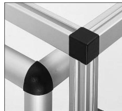
Eckwinkel werden mit selbst-schneidenden Schrauben in der Zentralbohrung der Profile befestigt. Kugelförmige oder quadratische Abdeckkappen werten die Ecken optisch auf und schützen vor Verletzungen.
