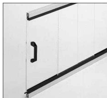
Das Schiebetürprofil zum Einklippen in Strebeprofile eignet sich für leichte Schiebetüren, die geringen Kräften quer zur Schieberichtung ausgesetzt sind.
