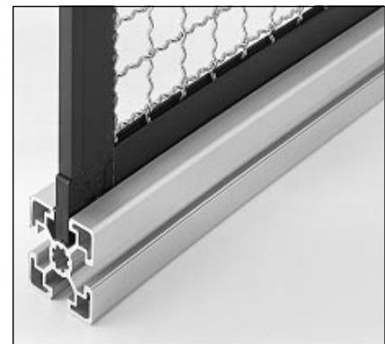
Aus Schutzgitterprofil A und Eckstücken B, C werden Rahmen für Wellengitter bis Drahtdurchmesser 3,1 mm oder Scheiben bis Dicke 6 mm aufgebaut. Der Rahmen wird außen auf die Strebuprofile geschraubt oder in die 10er Profilnute geschoben.
