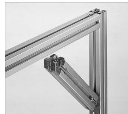
Mit dem Verbinder 45° werden Profile unter 45° einfach und stabil verbunden, z. B. Diagonalstreben zur Aussteifung.
