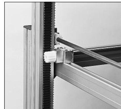
Zahnstange und Ritzel werden z. B. bei großen Führungsbreiten eingesetzt, um das Verkanten bei der Bewegung zu vermeiden. Zur Verbindung zweier Ritzel werden handelsübliche Sechskantwellen 10H9 verwendet.
