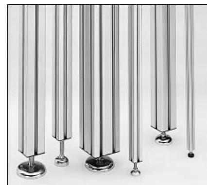
Gelenkfüße für Maschinengestelle, Tische o. ä. gleichen Bodunebenheiten aus. Die Spindeln können bis 5° geschwenkt und die Einschraubtiefe innerhalb des Verstellbereichs stufenlos variiert werden.
