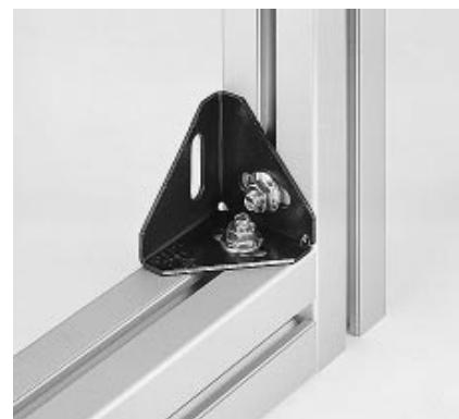
Blechwinkel zum rechtwinkeligen Verbinden von Profilen. In der Bohrung der Versteifungsrippe können Flächenelemente verschraubt werden.
