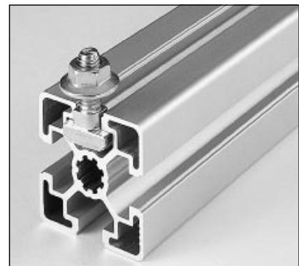
Hammerschraube mit Bundmutter zur Befestigung von Platten, Winkeln oder Spannpratzen. Die Riffelung der Hammerschraube bricht die Elokal-schicht des Profils auf und stellt damit die elektrische Leitfähigkeit sicher.
